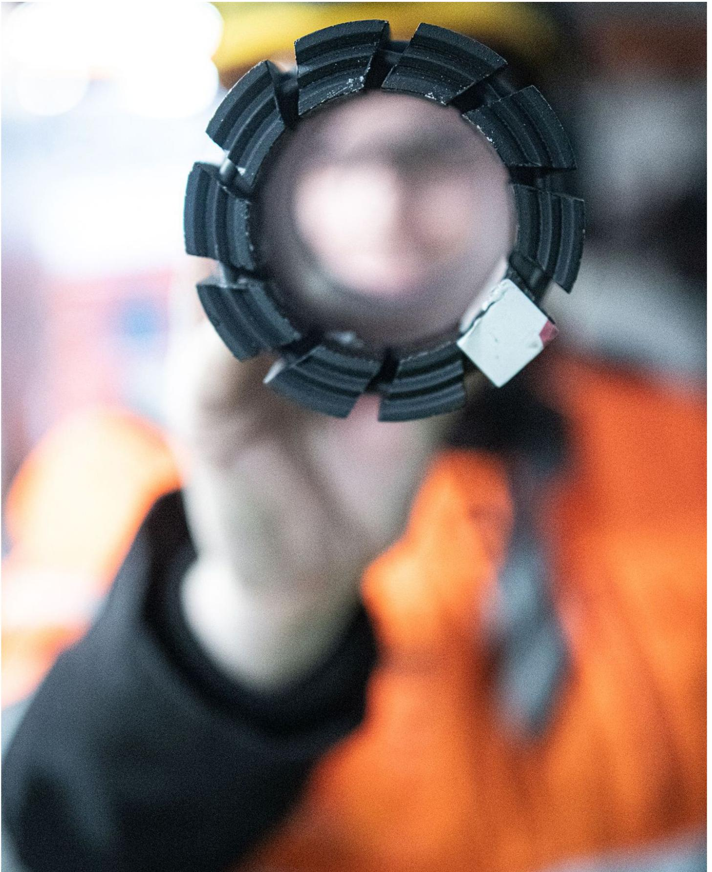
Die Diamantschaufelmühlen des Bohrers rocken bis zu 50 Meter pro Tag von seiner besten Seite.
